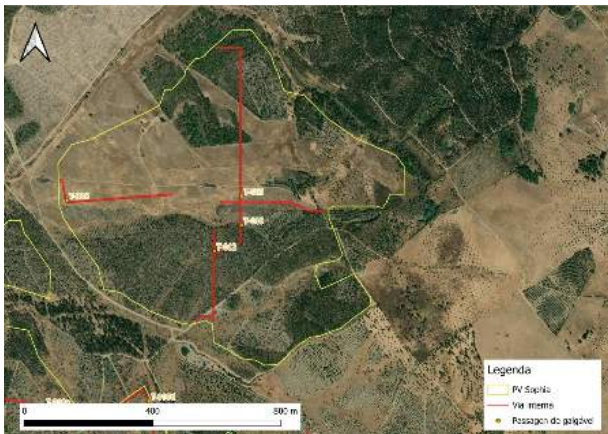
Exemplo da distribuição de valas e passagens hidráulicas numa área a oeste da central fotovoltaica Sophia
