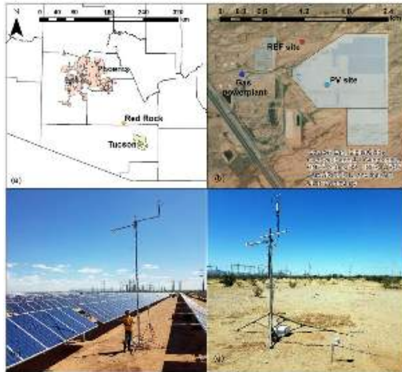
Figura 5. Mapas e fotografias de: (a) A localização geográfica da central, (b) layout da central e indicação dos pontos de medição, (c) sonda instalada na central PV, (d) sonda instalada no local de referência (retirado de [3])
