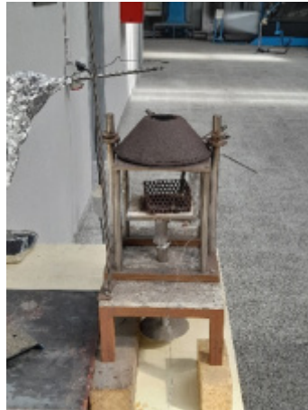
Figura 3. Cone calorimétrico com sonda de amostragem de gases instalada.
