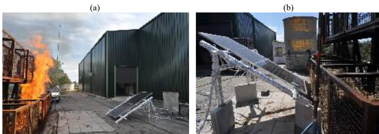
Figura 5. Fotografias dos ensaios de validação com frente de chamas próxima: a) frente de chamas a 3,0m; b) painéis a 0,2m do leito de combustíveis.
