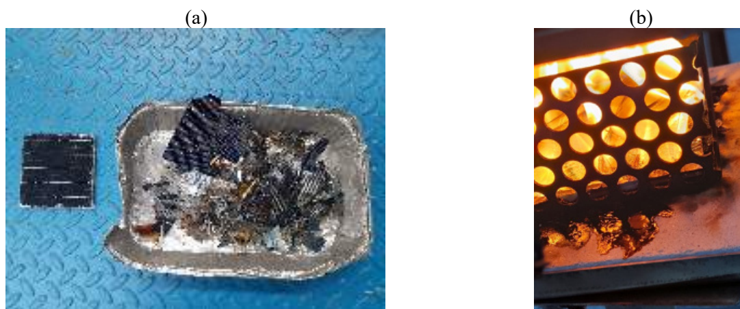
Figura 8. Fotografias que evidenciam a fratura do vidro das amostras (a) e da libertação de fumos acompanhada da fusão do material polimérico (b).
